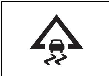
Когда система функционирует, мигает сигнализатор неисправности системы StabiliTrak®/противобуксочной системы.
