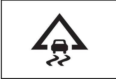
Когда система ограничивает пробуксовку колес, мигает сигнализатор неисправности системы Stabilitrak®/противобуксовочной системы.
